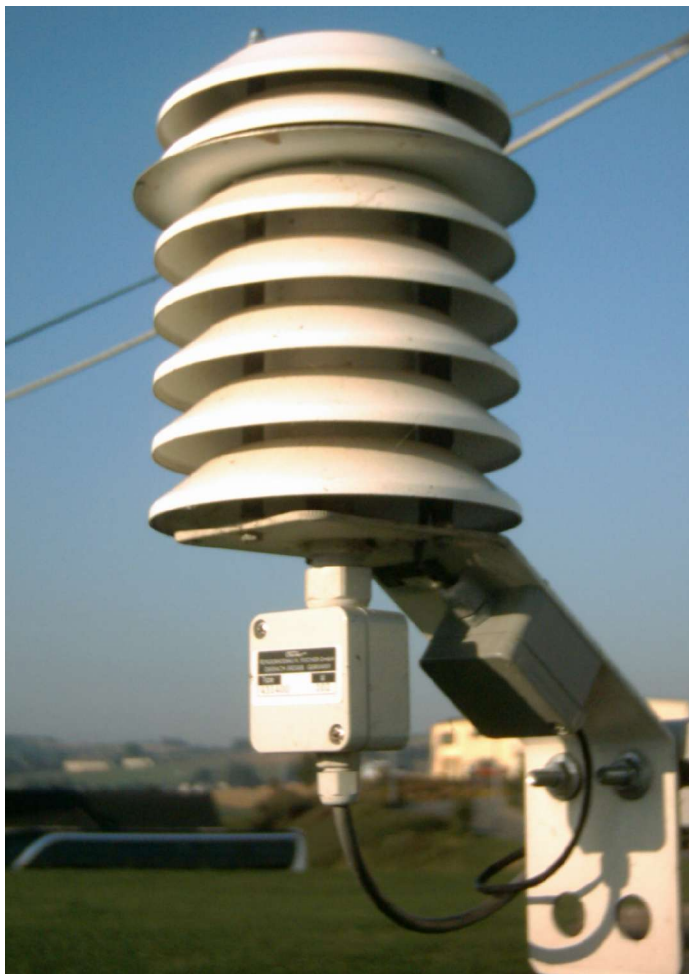
Montagebeispiel: Strahlungsschutzhütte 439102 mit Messwertgeber 431200
