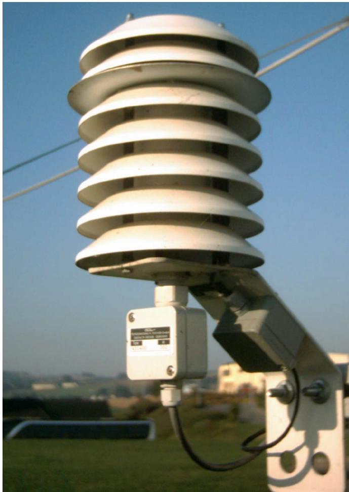
Montagebeispiel: Strahlungsschutzhütte 439102 mit Messwertgeber 431200
