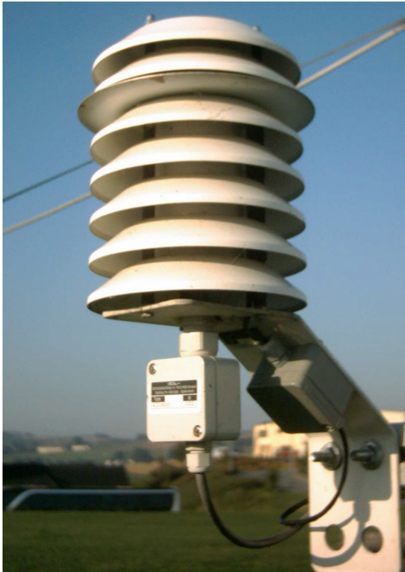
Montagebeispiel Strahlungsschutzhütte 439102 mit Messwertgeber 431400
